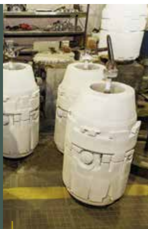
Песчаные стержни, создающие внутреннюю форму модуля ракеты
