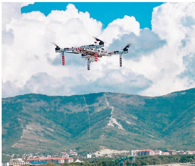
*Дрон-перехватчик Т-01 (Сокол) – компактный БПЛА для использования полезной нагрузки до 20 кг. Перехват осуществлялся с помощью отстрела сетки по дрону-нарушителю. Распознавание и наведение на цель осуществлялось камерой и бортовым компьютером, установленным на Т-01 (Сокол).*
