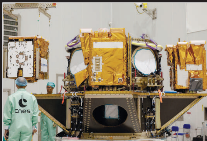
РИС. 5. Установка КА ELISA на адаптер
