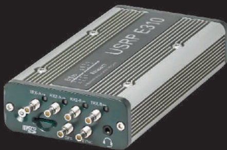
рис. 14. Полезная нагрузка USRP E310 из состава КА РЭН Hawk
