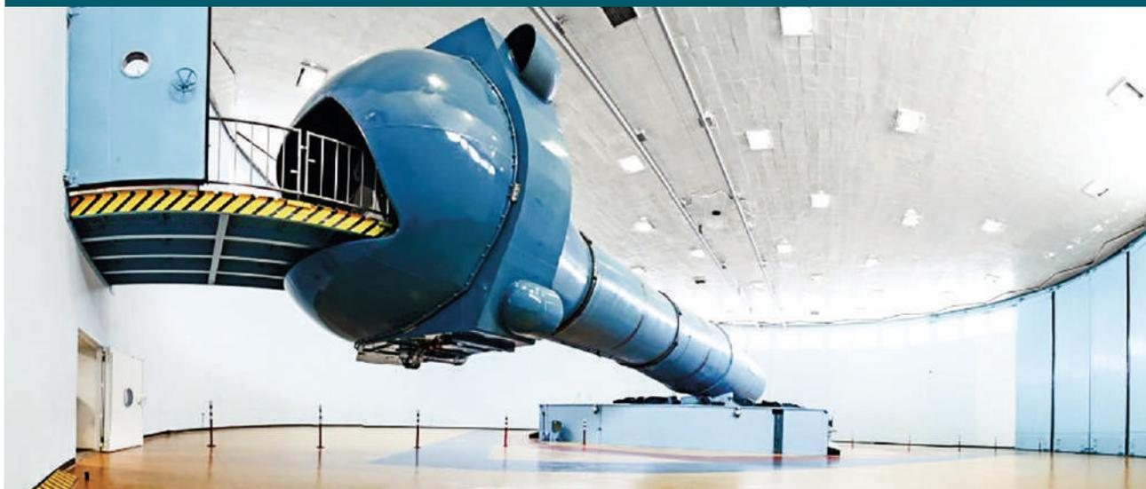
При  $\approx 21,16$  оборота в минуту ( $\approx 1269,74$  оборота в час) перегрузка достигнет  $\approx 9 g$ , то есть того расчетного значения, которое используется сегодня для тренировки организма космонавта при моделировании нештатной ситуации, возникающей при спуске с орбиты ИСЗ по аварийной баллистической траектории.
