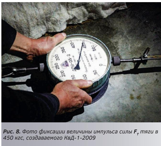
Рис. 8. Фото фиксации величины импульса силы  $F_T$  тяги в 450 кгс, создаваемого КвД-1-2009
