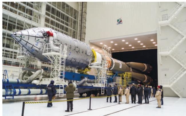
*Вывоз ракеты из МИК РН на стартовый комплекс. Ракета-носитель с космической головной частью на стартовый комплекс доставляется по железной дороге специальным составом из тепловоза, агрегата термостатирования, агрегата прикрытия и транспортно-установочного агрегата.*
