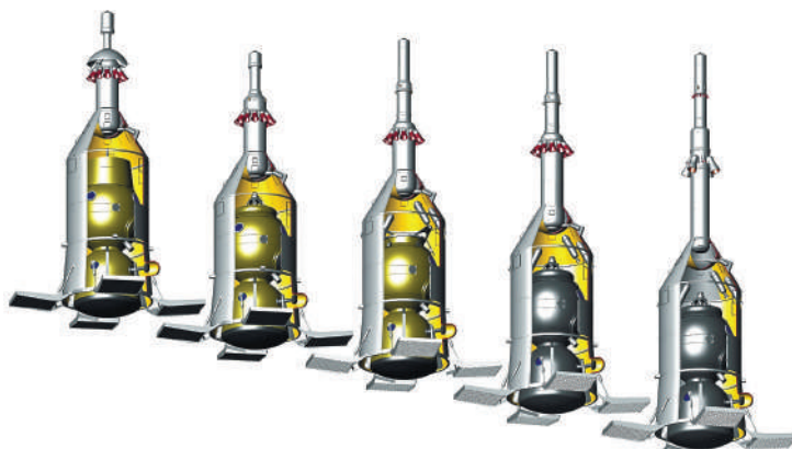
Рис. 2 Конфигурация уводимой части головного блока с двигательной установкой системы аварийного спасения менялась в зависимости от модификаций
